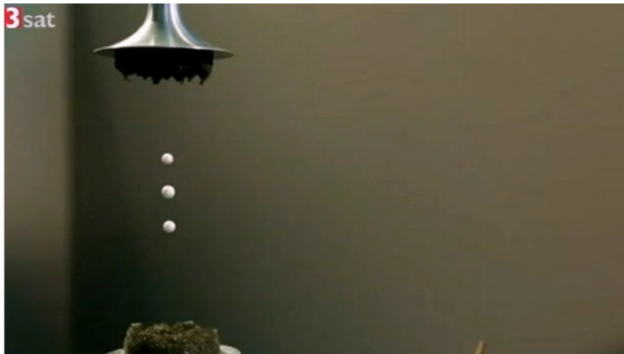
Abb. 11: Prinzip der Levitation durch Schall
